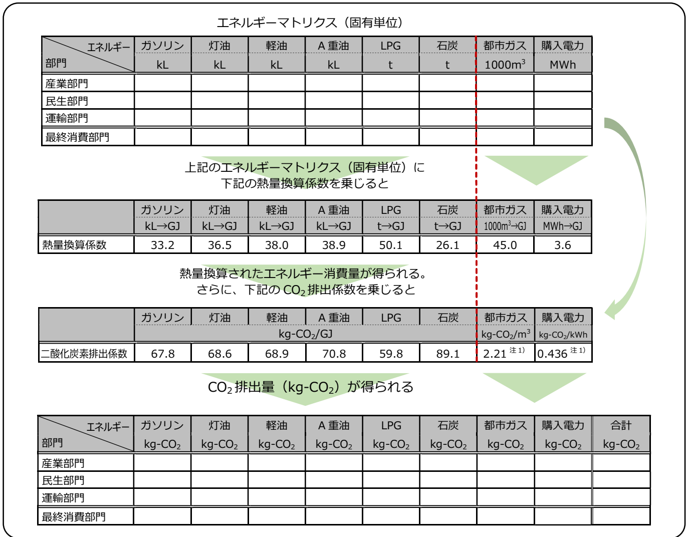
図1 エネルギーマトリクスとエネルギー消費量、CO 2 排出量の算出
